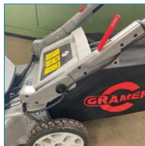
Lenkholmarretierung und Verstellung komplett aus Aluminium.
