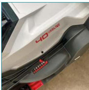
Die Schnitthöhe kann zentral über einen Knopfdruck von 20 – 70mm verstellt werden.
