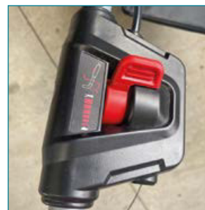
Stufenlose Geschwindigkeitsregulierung von 1,8 km/h – 5,4 km/h.
