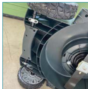
Durchgehende Achse vorne und hinten sorgen für einen stabilen Aufbau.
